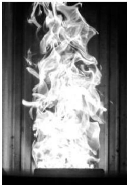
Wysoki płomień. Czysta szyba i wnętrze. Temperatura w komorze spalania > 350°C
